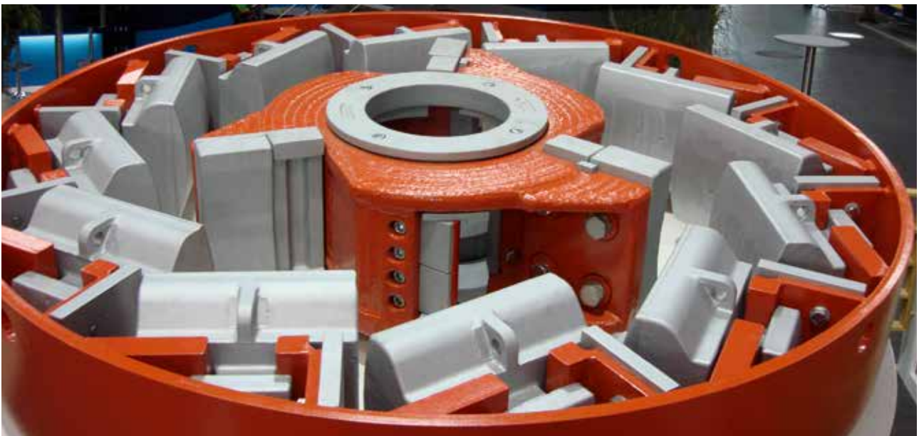
MP 18 mit Prallring / MP 18 with impact ring
